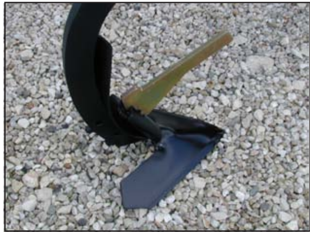
Abb. 4.08: Clip-On Schar mit Entriegelungswerkzeug
